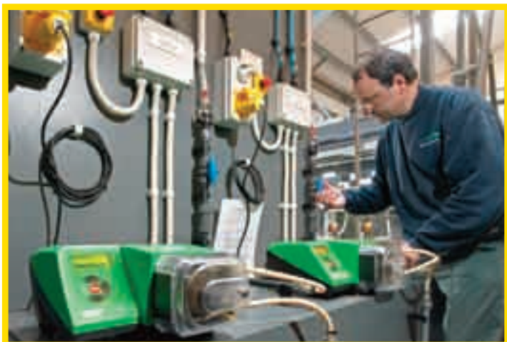
500系列产品替代了隔膜泵，被应用在凝结剂定量添加线上
